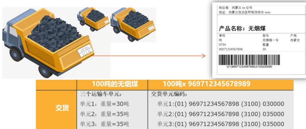
图 14 商品条码在煤炭交货单上的应用
