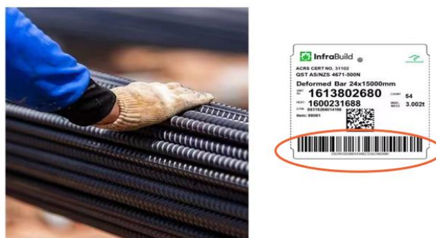
图 15 商品条码在钢筋交货单上的应用
