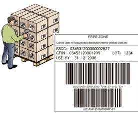
GS1-128 是一种线性条码符号。它可以配合 GS1 应用标识符（AI）来承载 GTIN、有效日期及有关运输等信息。所用的条码可以根据商业应用的数据需要以及包装尺寸而定。必要时，还可补充使用二维条码符号 Data Matrix。
